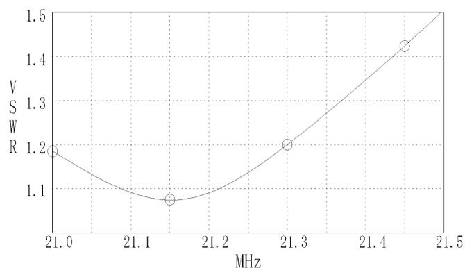
地上高20mに仮設し周囲に大きな障害物の無い状態で測定した値です。SWRは周囲の状態により異なった値を示します。同一のタワーに他のアンテナを同居させる場合、他のアンテナの種類によっては大きな悪影響を受けることが有りますので注意が必要です。
